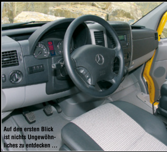
... nur die Sperrenschalter und der Reduktionshebel verraten den Offroader.
