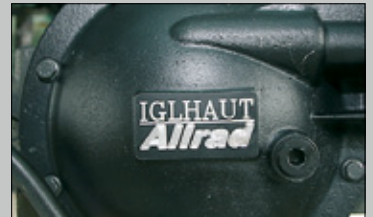
Die hintere Sperre: eine Eigenentwicklung.
