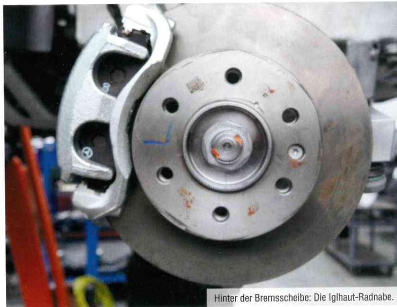
Hinter der Bremsscheibe: Die Iglhaut-Radnabe.
