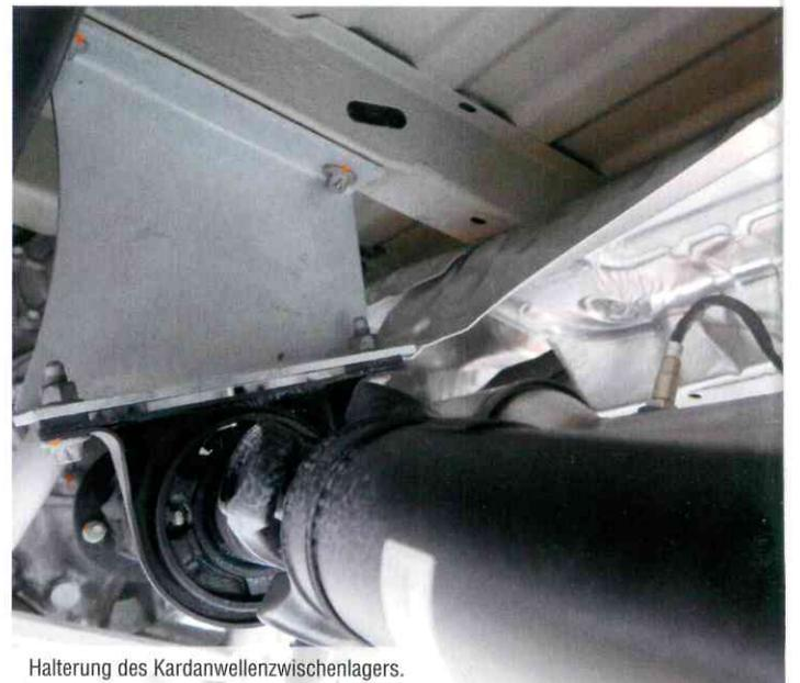
Halterung des Kardanwellenzwischenlagers.
