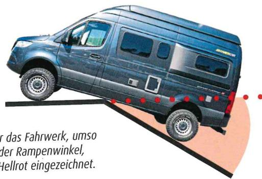
Je höher das Fahrwerk, umso größer der Rampenwinkel, hier in Hellrot eingezeichnet.
