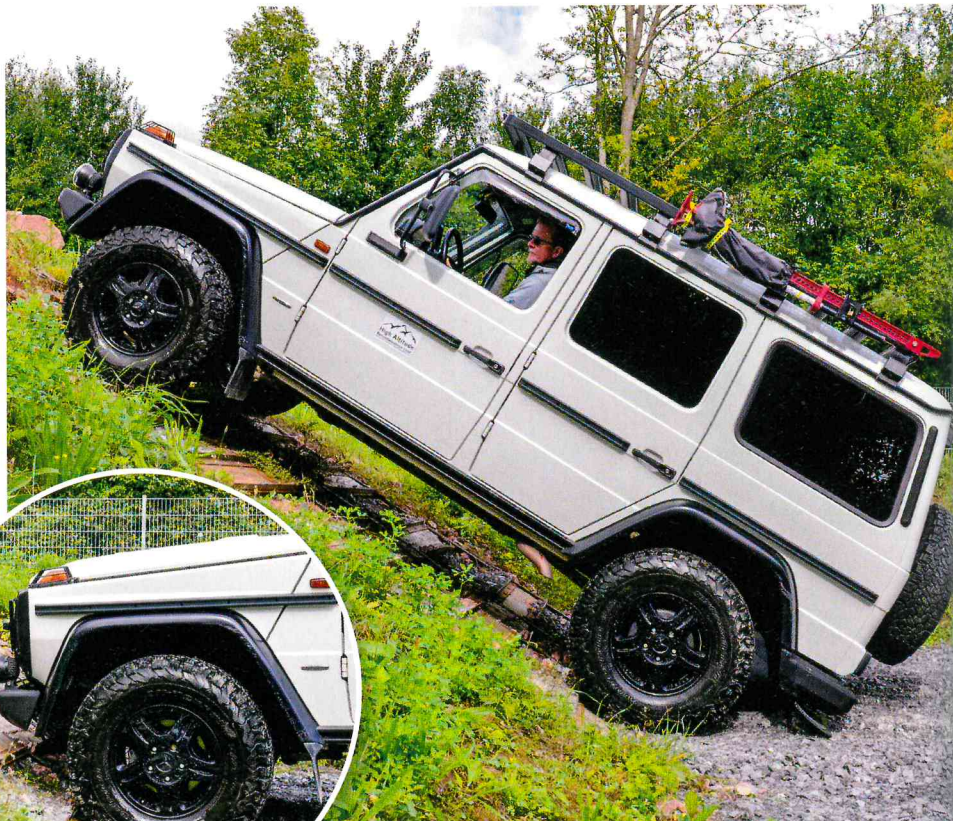
An der 40-Grad-Steigung müssen wir beim Sprinter ein paar Steine unterlegen. Der vordere Böschungswinkel ist etwas geringer, dafür hat er mehr Luft unterm Hintern. Die Steigung meistern beide spielend.
