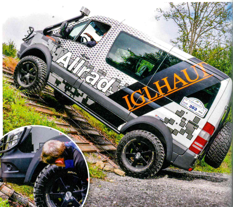
An der 40-Grad-Steigung müssen wir beim Sprinter ein paar Steine unterlegen. Der vordere Böschungswinkel ist etwas geringer, dafür hat er mehr Luft unterm Hintern. Die Steigung meistern beide spielend.
